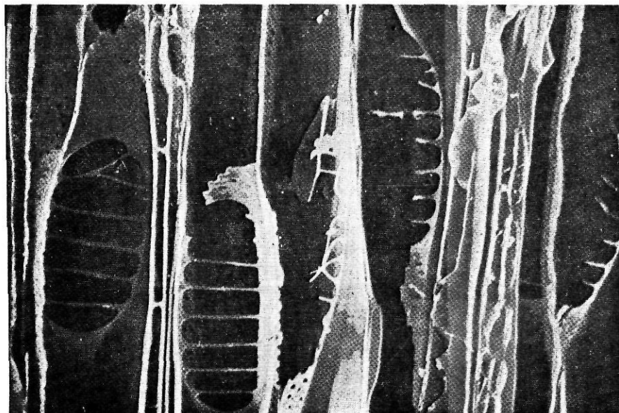
Carbó de fusta de pi roig ( Pinus silvestris ), pla radial x 925. Fotografia en microscopi electrònic (segons J. L. Vernet).
