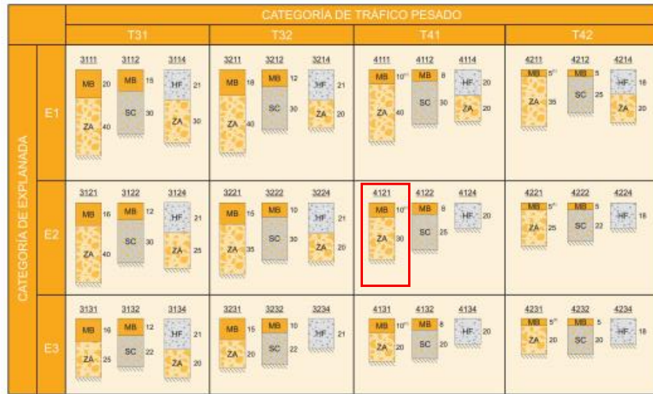
Imatge 2. Seccions de ferm segons tràfic i explanada
