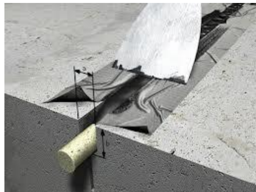
Figura 77. Imatge segellat de junta de dilatació amb cordó obturador en el fons del tall.
