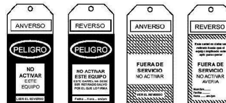
Cartells de senyalització de treballs per a la col·locació en les instal·lacions afectades.
