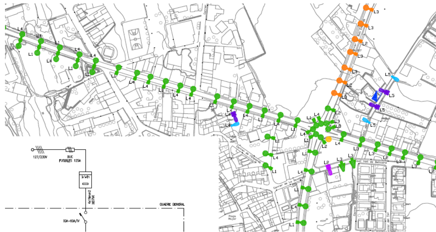
Figura 15. Plànol xarxa enllumenat públic existent.
