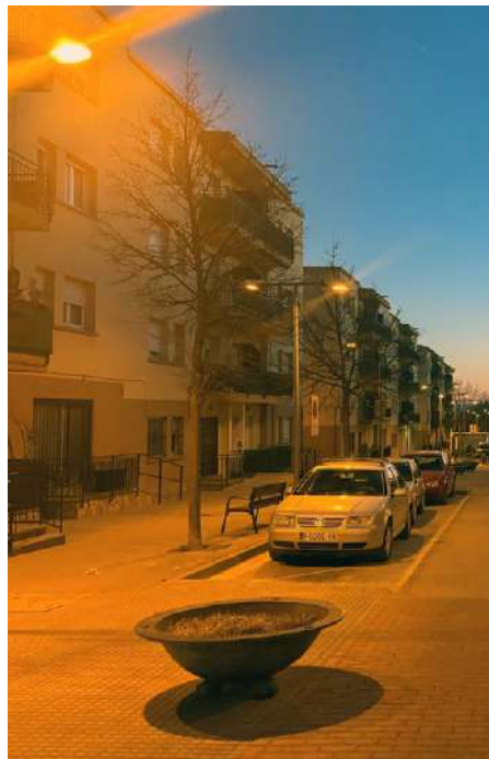
A l'esquerra, un fanal amb llums de vapor de sodi; a la dreta, un dels ja substituïts amb leds
