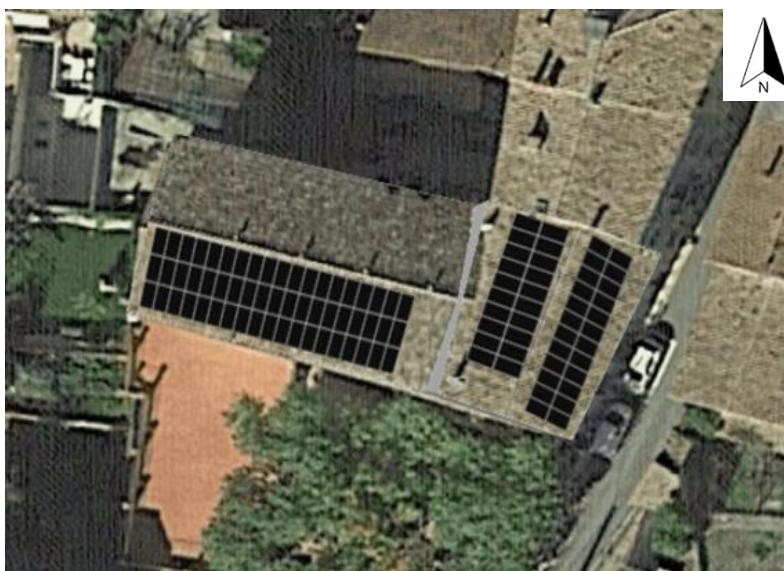
Figura 24. Fotomuntatge instal·lació Proposta 2 Font: SolarEdge Designer
