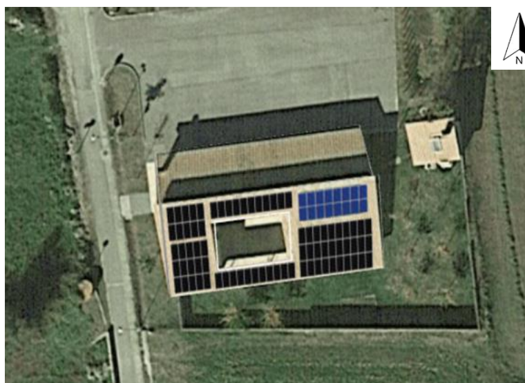
Figura 26. Fotomuntatge instal·lació Fase II Font: SolarEdge Designer
