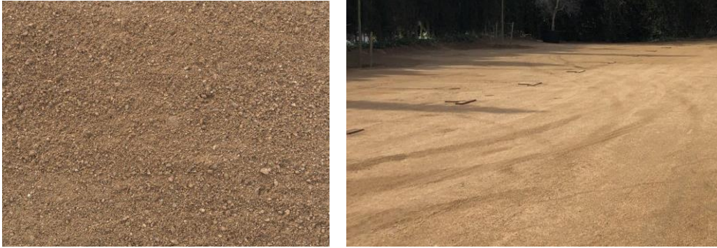
Foto 28. Aspecte de la textura i color del sauló i aspecte d'aquest material compactat.
