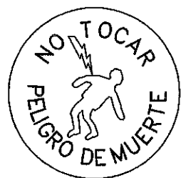
Señal de peligro de muerte
