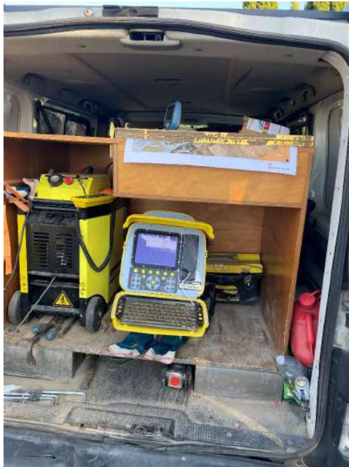
Figura 9. Equips per la inspecció amb càmera.
