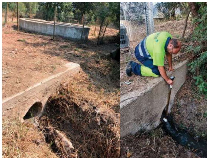
Figura 4. Punt d'aforament de cabals (punt 1) setembre 2019. Durant la campanya, el punt de la foto de l'esquerra (sobreeixidor) no sortia aigua i el punt de la foto de la dreta sí (sortida EDAR actual).
