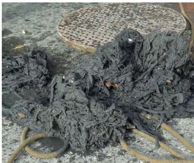
Manyoc de draps que vam interceptar en un col·lector que s'estava obturant.
