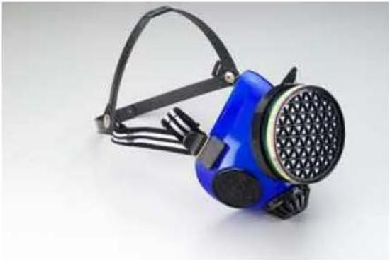
Semimascareta de protecció respiratòria contra la pols i partícules fines i per a la prevenció de malalties de tipus fibrògen: silicosi, asbetosi i neumoconosi.
