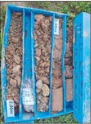
Fotografia 2. Material recuperat en el sondieg S-1 entre les cotes de 0.00 a 3.00 metres de profunditat.
