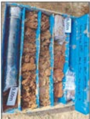
Fotografia 4. Material recuperat en el sondag 5-2 entre les cotes de -6,00 a -9,00 metres de profunditat.
