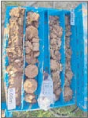
Fotografia 4. Material recuperat en el sondieg S-1 entre les cotes de 6.00 a 9.00 metres de profunditat.
