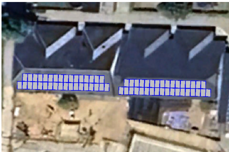
Figura 4. Croquis de la instal·lació fotovoltaica.
