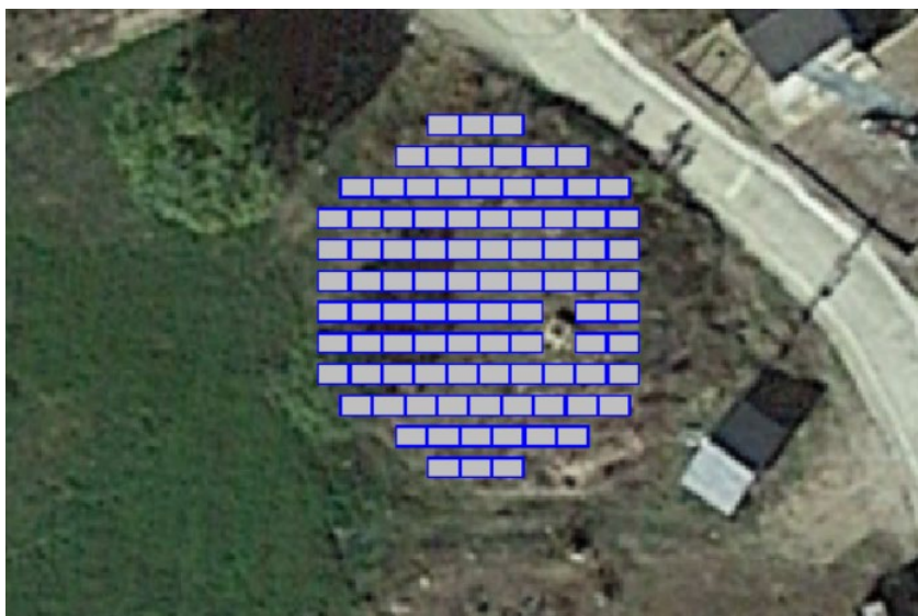
Figura 12. Croquis de la instal·lació fotovoltaica.
