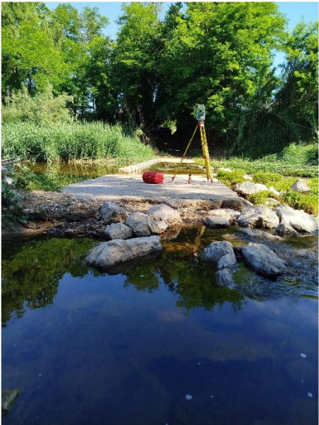
Base 01 col·locada sobre la passera de formigó.
