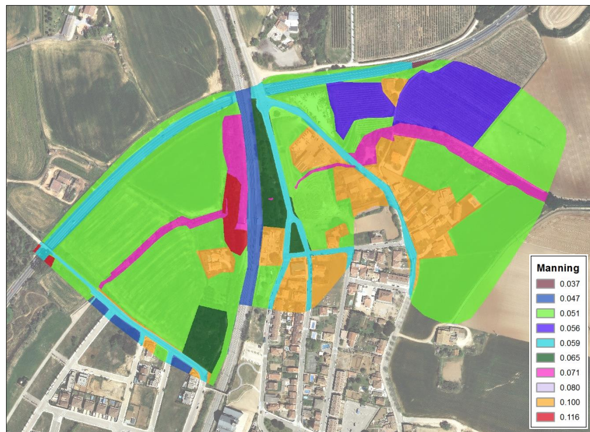
Distribució dels coeficients de rugositat de Manning adoptats en l'àmbit de la riera de Can Bosquets
