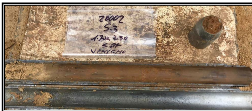
Materials de la capa A, recuperats a un assaig SPT.
