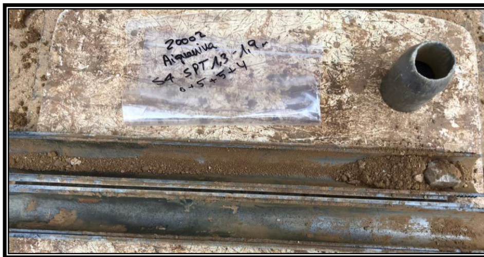
Materials de la capa R, recuperats a un assaig SPT.
