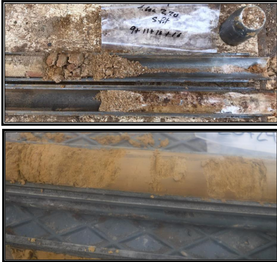
Aspecte dels materials de la capa B. A dalt un nivell sorrenc i a baix un nivell d'argila sorrenca carbonatada.
