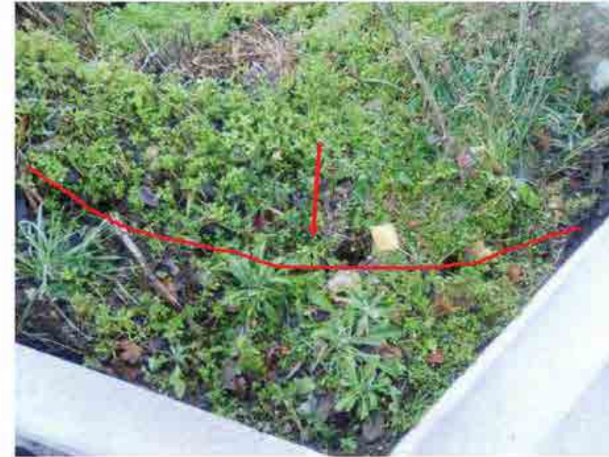
Figura 6. Esquerda que apareix en aquest sector i que pot provocar una futura esclavissada.
