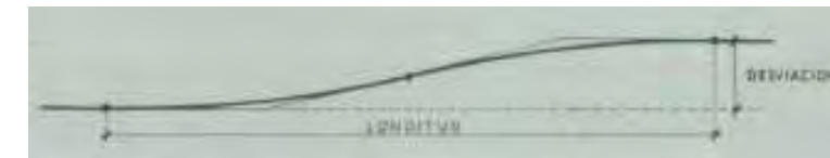
Imatge 3. Longitud mínima per desviament paral·lel d'un carril. Font: Norma 8.3-IC. Ministerio de Fomento.
