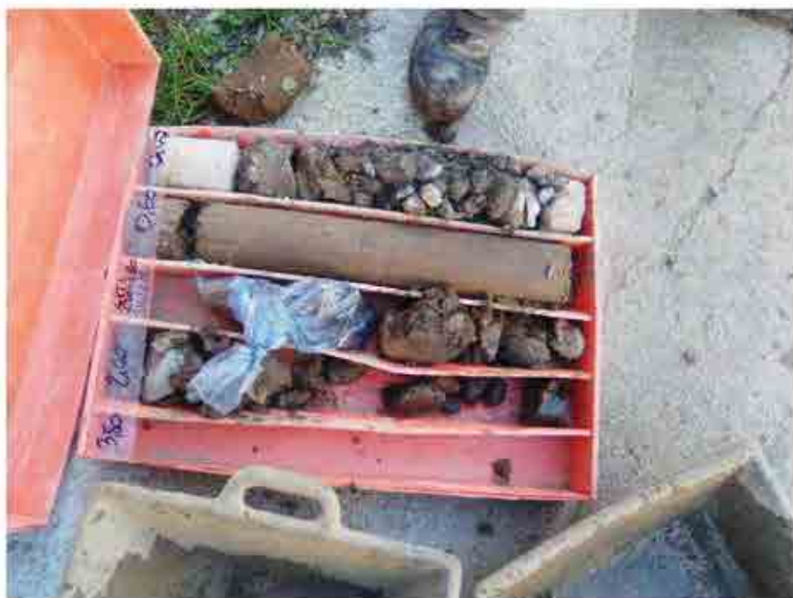
S2 – Mostres extretes del sondatge.
