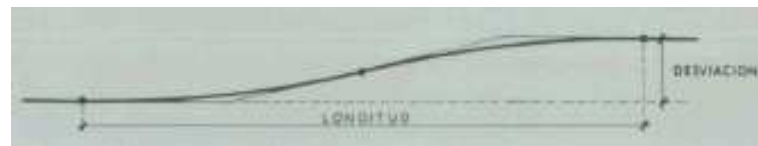
Imatge 9. Longitud mínima per desviament paral·lel d'un carril. Font: Norma 8.3-IC. Ministerio de Fomento.
