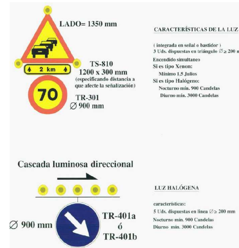
Imatge 7. Senyals posició i pre-avis, tancament carril dret. Senyalització obres mòbils. Font: Manual de ejemplos, Ministerio de Fomento.
