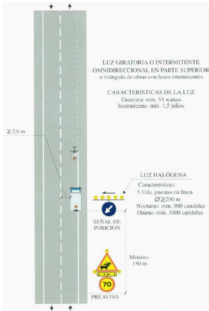
Imatge 6. Zona d'obra: en el voral del carril, treballs pintant marques vials. Senyalització obres mòbils, en via de doble sentit de circulació calçada única amb 2 carrils. Font: Manual de ejemplos, Ministerio de Fomento.
