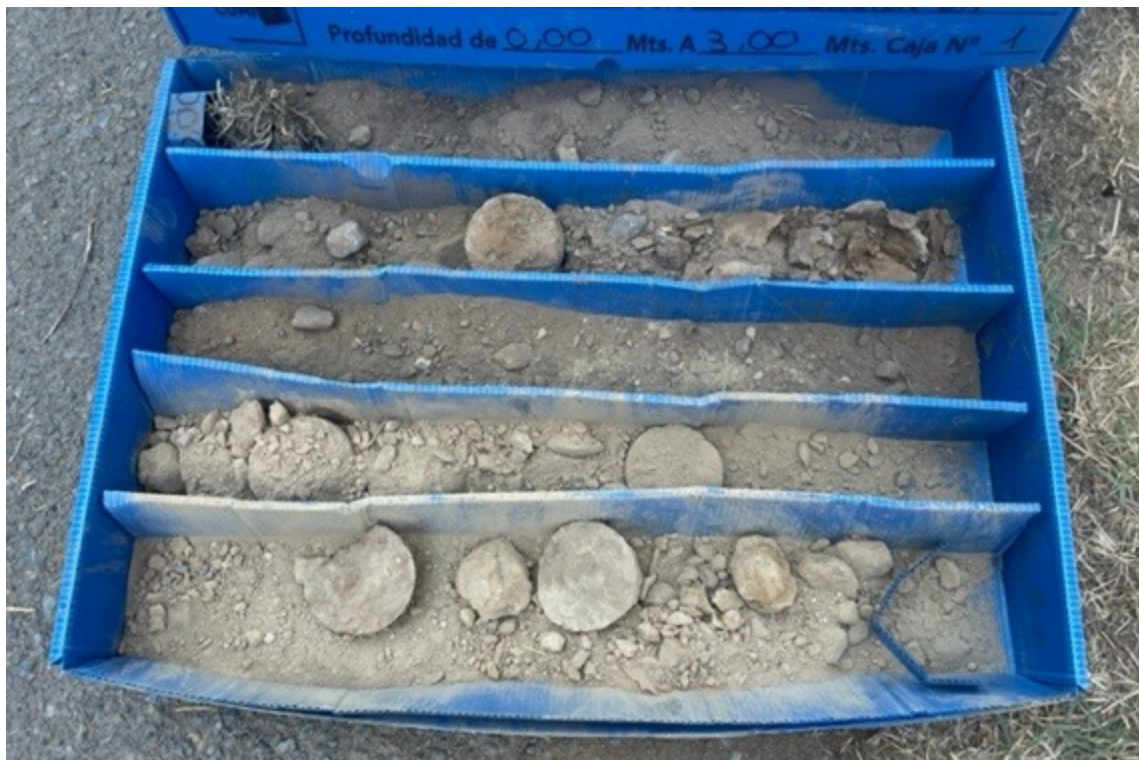
Fotografia de la punta del portatestimoni de l' assaig SPT- 1 realitzat in situ en el sondeig S-1 a la fondària d' 1,20 m a 1,27 m i detall de la caixa de recuperació del testimoni del sondeig de la fondària de 0 m a 3 m.
