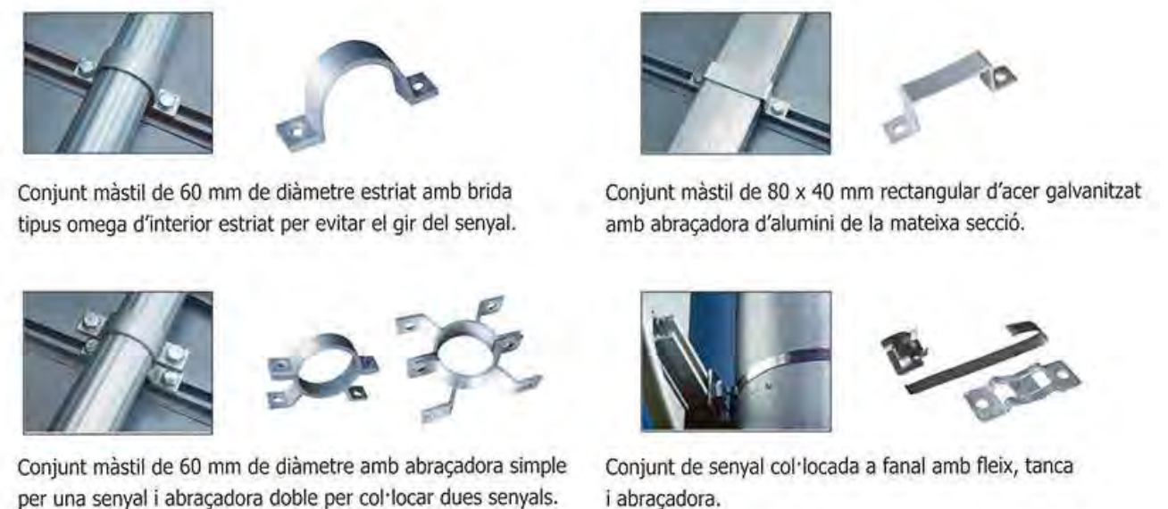
Figura 170. Sistemes de subjecció plaques d'alumini.
