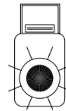
Balsa Intermitent llamejuejant amb cèl·lula fotoelèctrica
