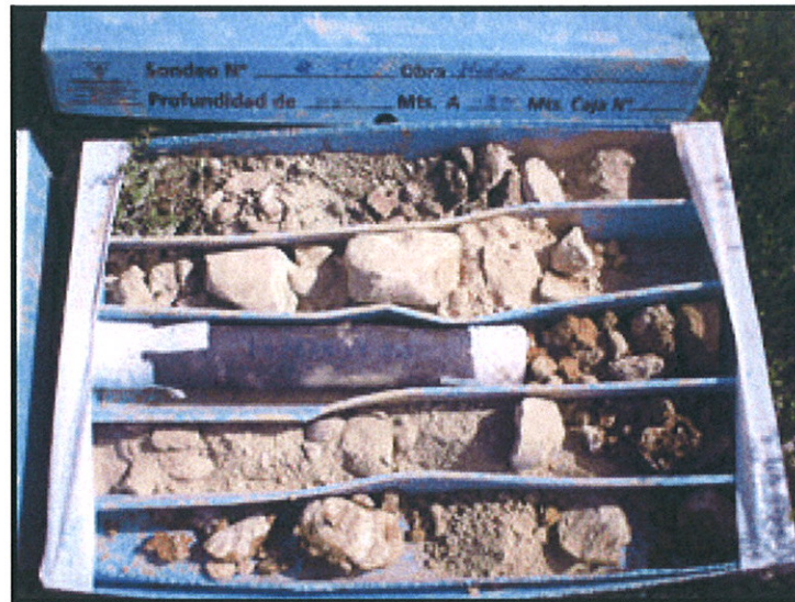
Foto 2: Materials extrets al sondeig S1.770-09, entre 0 i -3 m de fondària.
