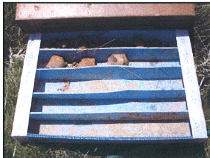
Foto 6: Materials extrets al sondeig S2.770-09, entre -3 i -4 m de fondària.
