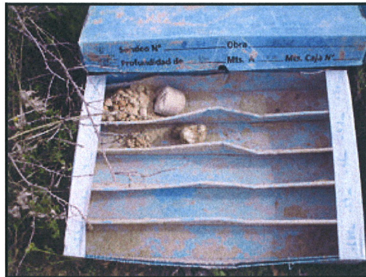
Foto 3: Materials extrets al sondeig S1.770-09, entre -3 i -4 m de fondària.
