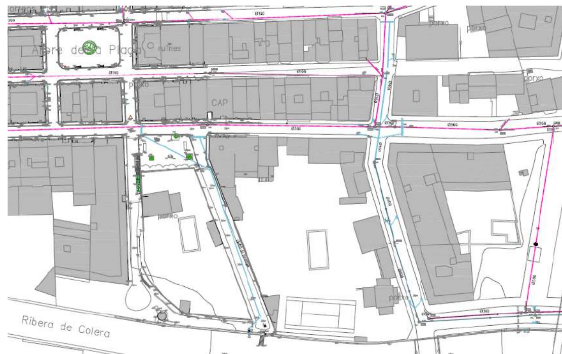
Xarxa pluvial existent
