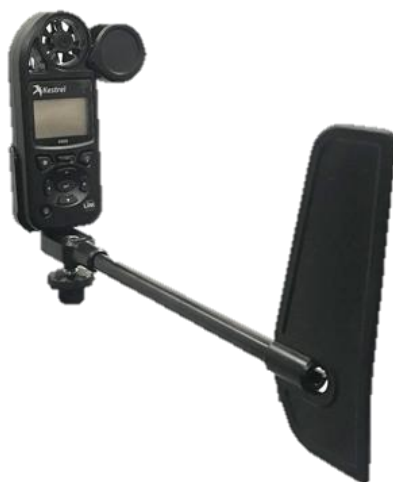
Figura A5. Sonda Kestrel5000, d'on s'obtenen valors de vent de l'àrea d'estudi.
