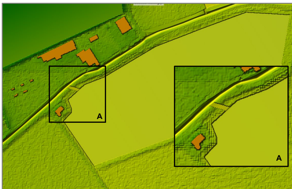
Detall de la closa MD_C_02 i del seu sobreexidor lateral.
