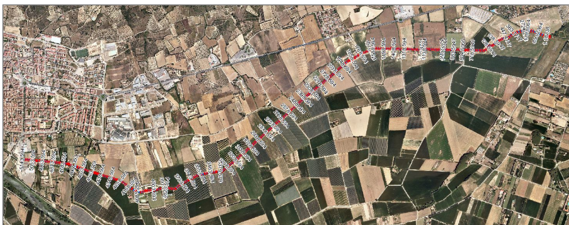
Esquema del model hidràulic realitzat amb HEC-RAS
